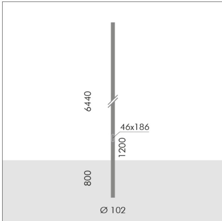
**S.2815****PALO CILINDRICO H 6,44m f.t., Ø102mm DA****INTERRARE**
