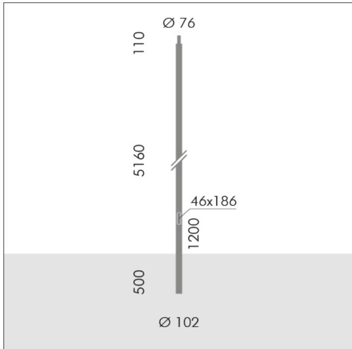
**S.2816****PALO CILINDRICO H 5,16m f.t., Ø102mm DA
