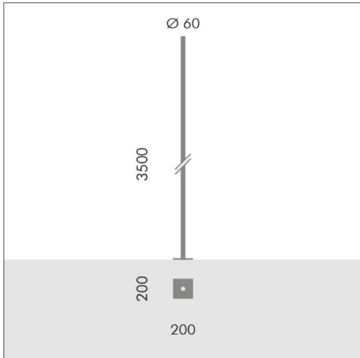
**S.2843****PALO CILINDRICO H 3,5m f.t., Ø60mm FLANGIATO**
