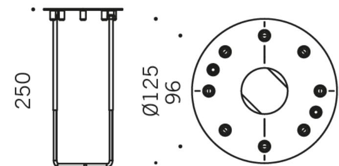
**S.5680****ANCHOR FLANGE TO BE CEMENTED TO THE GROUND**
