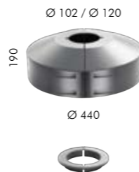
S.2809 DEKORATIVE ABDECKUNG FÜR BODENPLATTE Sowohl für Mast mit Flanschplatte oder Erdstück D102mm oder D120mm Ausführung in Aluminiumdruckguss.
