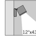
**S.1513W Faisceau Elliptique avec lentilles**
