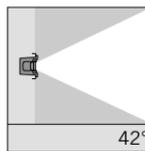
**S.3617.19 Faisceau Flood avec lentilles**
